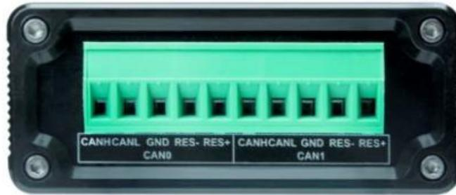
如图所示，ACUSB 卡的 CAN 端口采用 OPEN 10 的螺丝压紧接线方式，端口功能描述如下：
