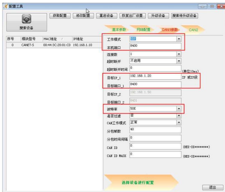
图 3.3 配置软件设置设备工作参数
